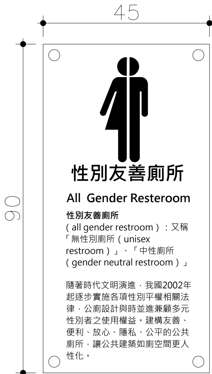
*性別友善廁所概念說明牌。 壓克力板雷射切割，四周金屬配件鎖固。
